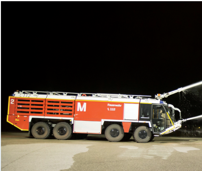
52 Tonnen Gesamtgewicht, bis 1.400 PS Motorleistung, 8x8 Allrad-fahrgestell, bis 19.000 Liter Löschmittel.
